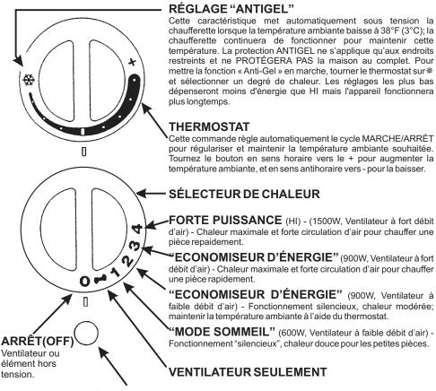
LAMPE-TÉMOIN - s'allume lorsque la chaufferette est sous tension.
